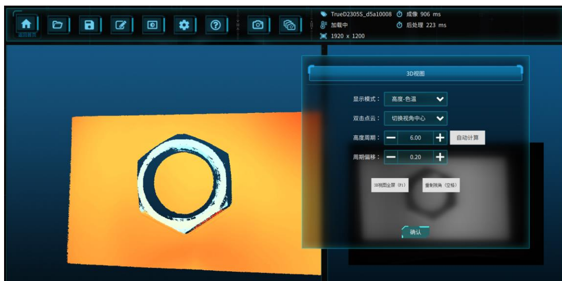
图 4.25 深度-色温模式显示 (修改高度周期)
